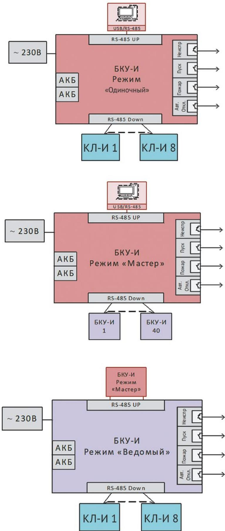
Схема подключения БКУ-И
