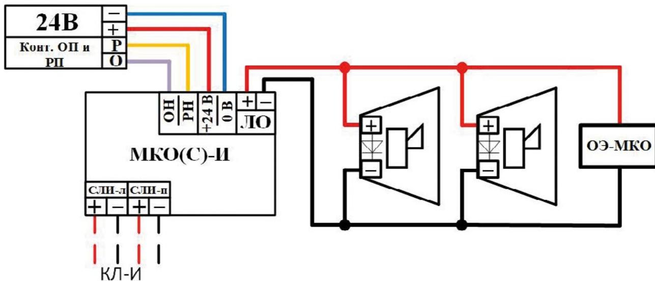
МКО(В)-И предназначен для подключения постоянно включенных световых оповещателей.
